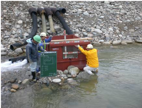
排水量の三角堰による測定状況
