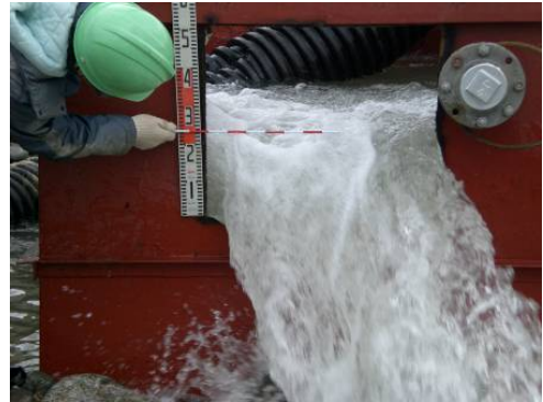
排水量の三角堰による測定状況
