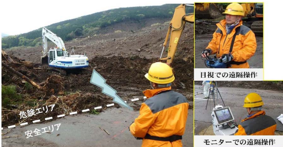
H28 熊本地震における遠隔操縦式バックホウの活動状況
