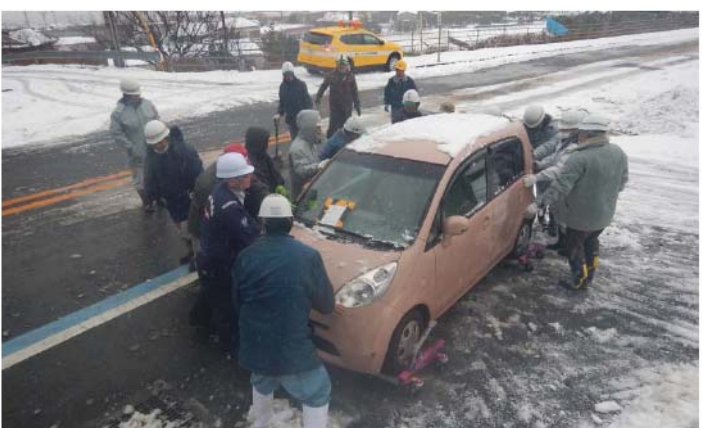
車両簡易移動器具を用いた車両移動
