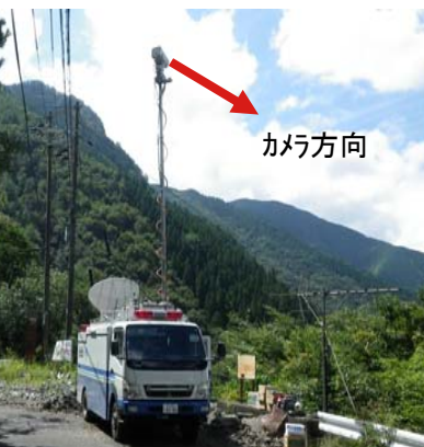
衛星通信車設営状況
