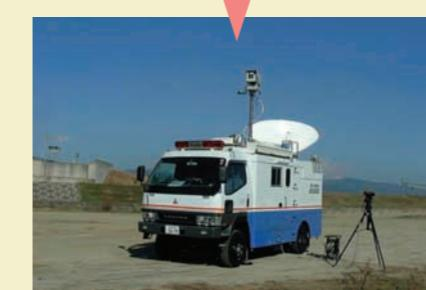
四国地方整備局内の専用回線を使用して、災害対策本部へ、災害現場の状況を画像伝送するとともに電話により伝えます。
