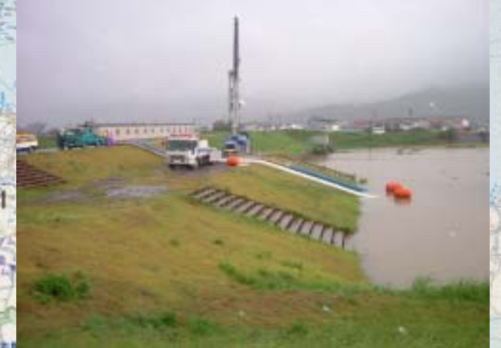
排水ポンプ車(吉野川支川ほたる川)
