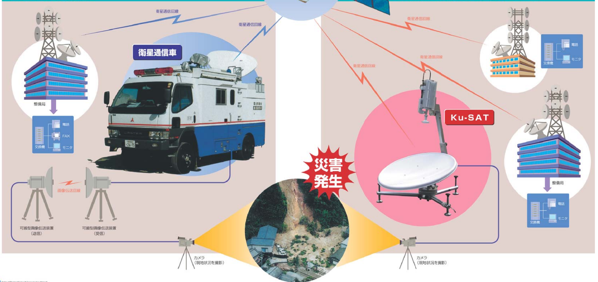
衛星通信車を利用した衛星通信の概念図
