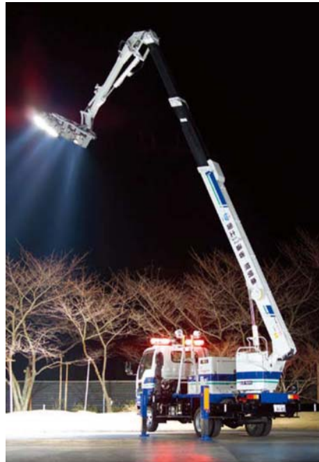
照明車(2kW×4灯)
